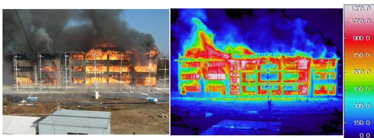
図 15 点火後 45 分の南側の熱映像と可視画像（温度スケールの範囲は 0~1200℃）
