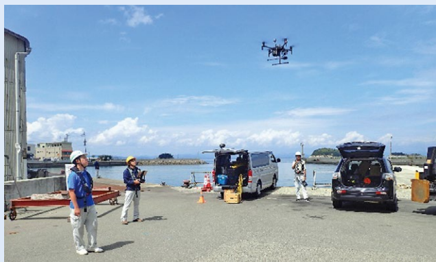
UAVによる港湾施設の点検のイメージ
