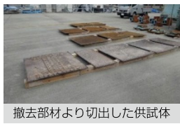
撤去部材より切出した供試体
