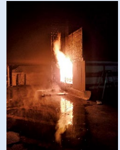
上階延焼防止対策の実験
