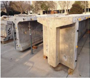
撤去部材より切出した供試体
