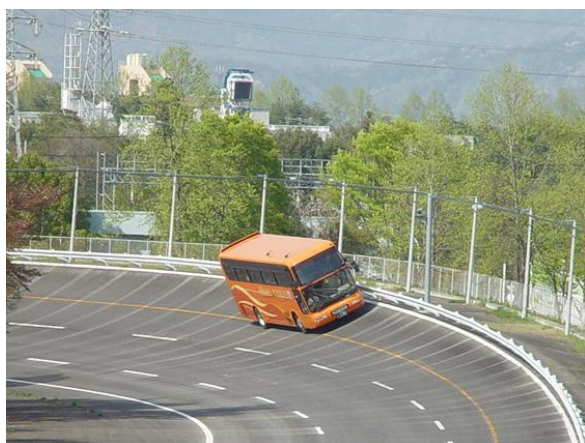
写真-1 試験走路による高速走行
