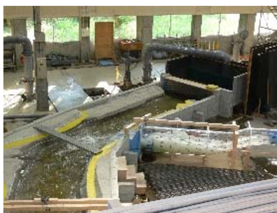
写真-2 ダム水理実験施設
