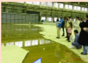
津波の発生を再現できる 「海洋沿岸実験施設」
