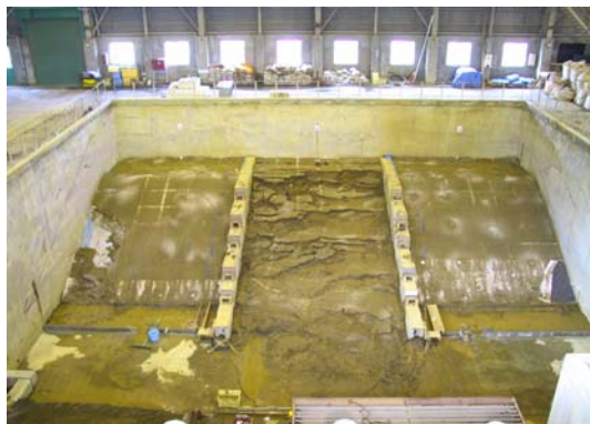
盛土実験施設(河川堤防降雨実験)
