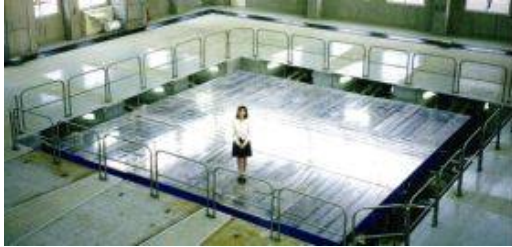
振動実験施設(三次元大型振動台)
