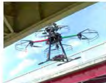
▲橋梁の損傷写真を撮影する技術
