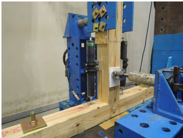
小屋組接合部の載荷試験の実施例
