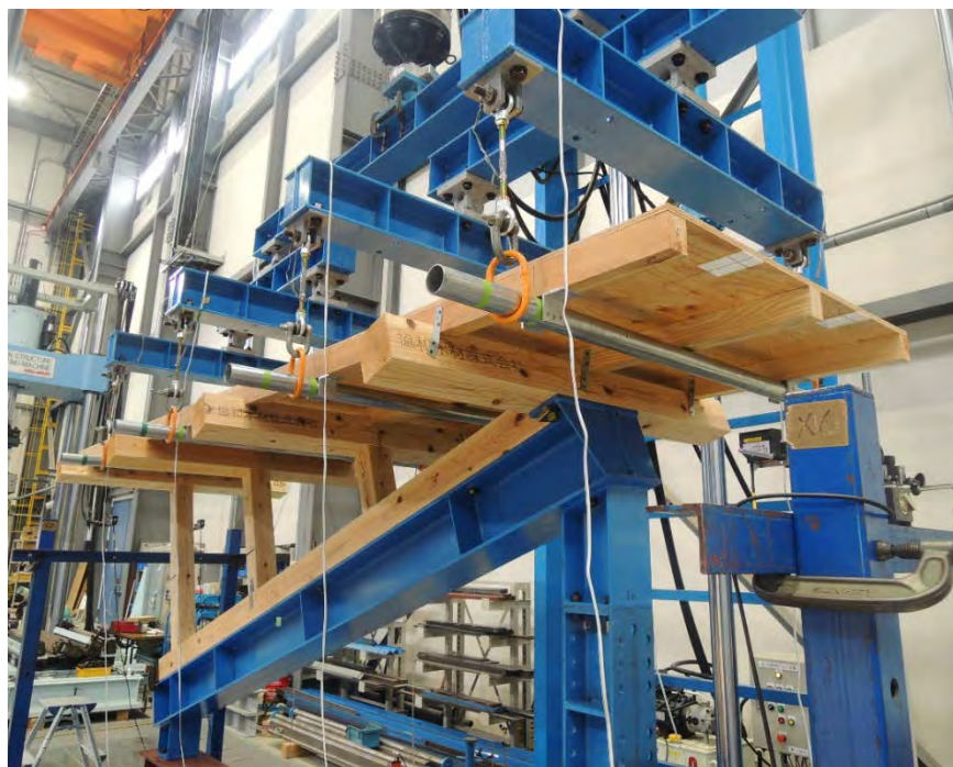
ユニット試験体の外観 (屋根勾配3寸5分)
