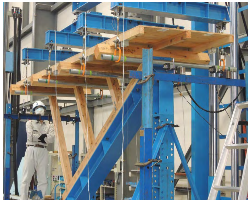
ユニット試験体の外観 (屋根勾配6寸)
