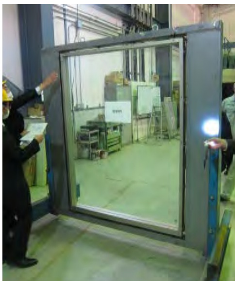
フロントサッシ乾式工法の試験体の例
