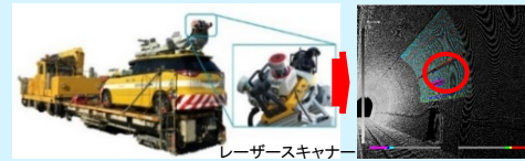
※道路用のデータ計測車両を鉄道台車に搭載し、けん引
