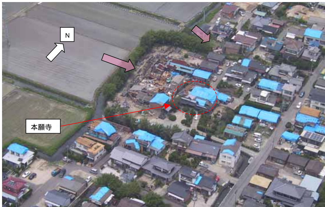
本願寺周辺（中央が本願寺（屋根の崩壊） 本願寺西側の縫製工場の崩壊）
