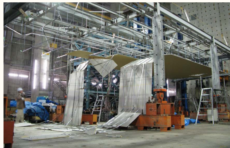
動的加振試験による衝突時衝撃力を含む外力等の評価
