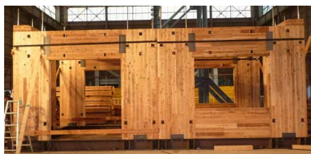
写真 2 試験体の 1 層部分
