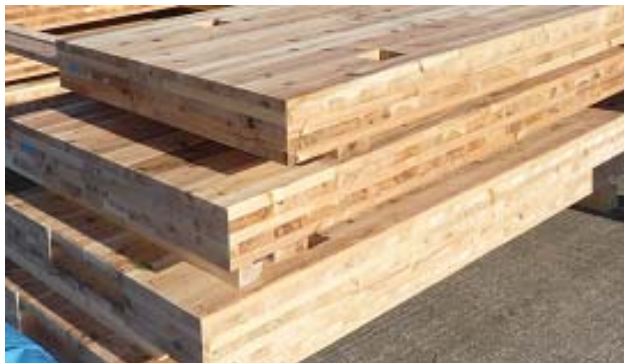
図1 クロス・ラミネイティド・ティンバー（CLT）パネル
