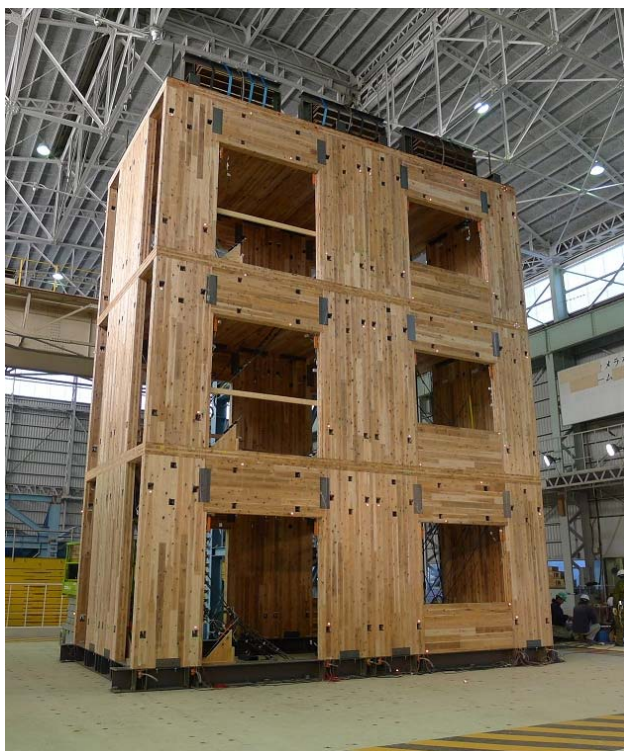
図2 CLT 構法による建築物の例（試験体）
