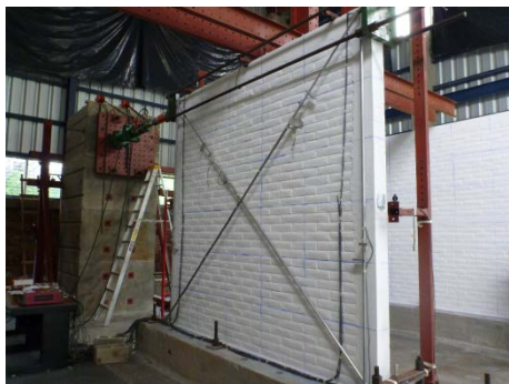
枠組組積造壁の 水平加力実験の様子
