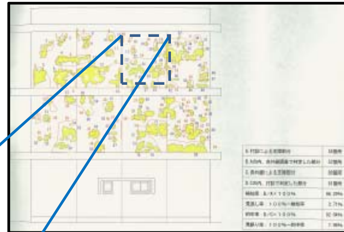
剥落危険性の有る箇所のデータ
