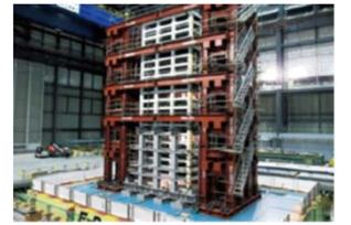
写真-1 20層RC造建築物の震動実験
