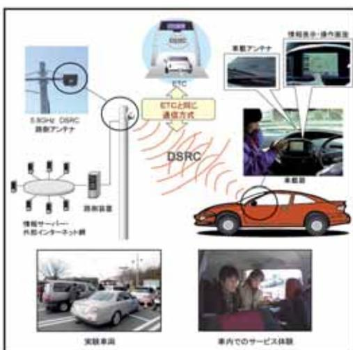
図 - 3 ETC 通信技術を活用した情報提供の仕組み
