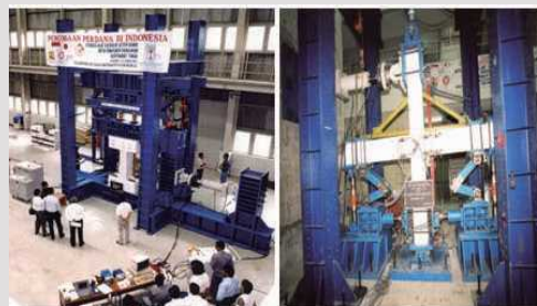
写真-1 要素構造実験状況（白い部分：試験体）
