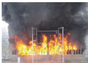
写真1 2階に延焼した時点の様子
