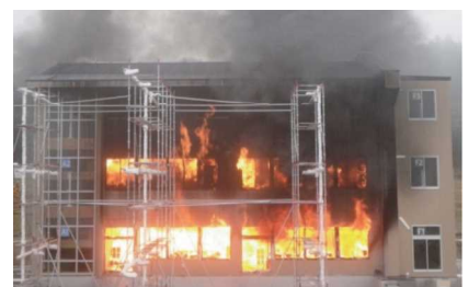
写真2 3階に延焼した時点の様子
