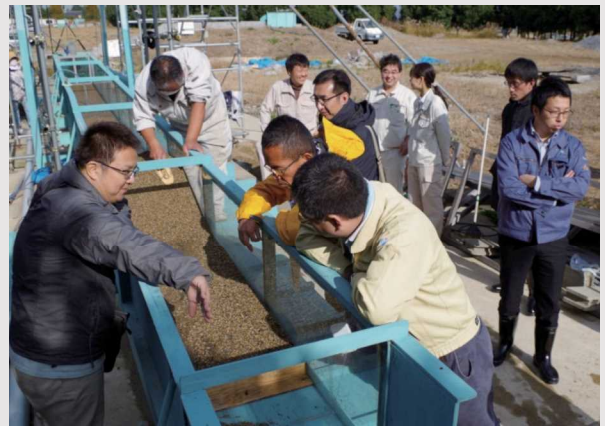
写真-1 水路実験による天然ダム決壊及びその対策に関する演習
