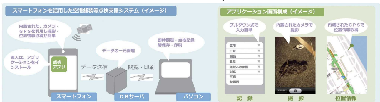
図2 スマートフォンを活用した空港舗装等点検システム(イメージ)
