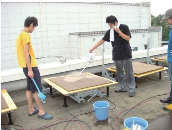
図1 保水性建材の実験サンプルへの散水
