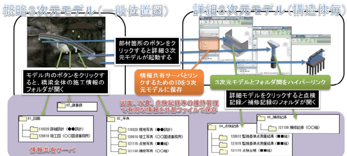
図 橋梁3次元モデルを活用した維持管理の情報管理システムのプロトタイプ
