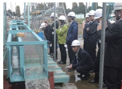
写真-2 天然ダムの越流模模型実験
