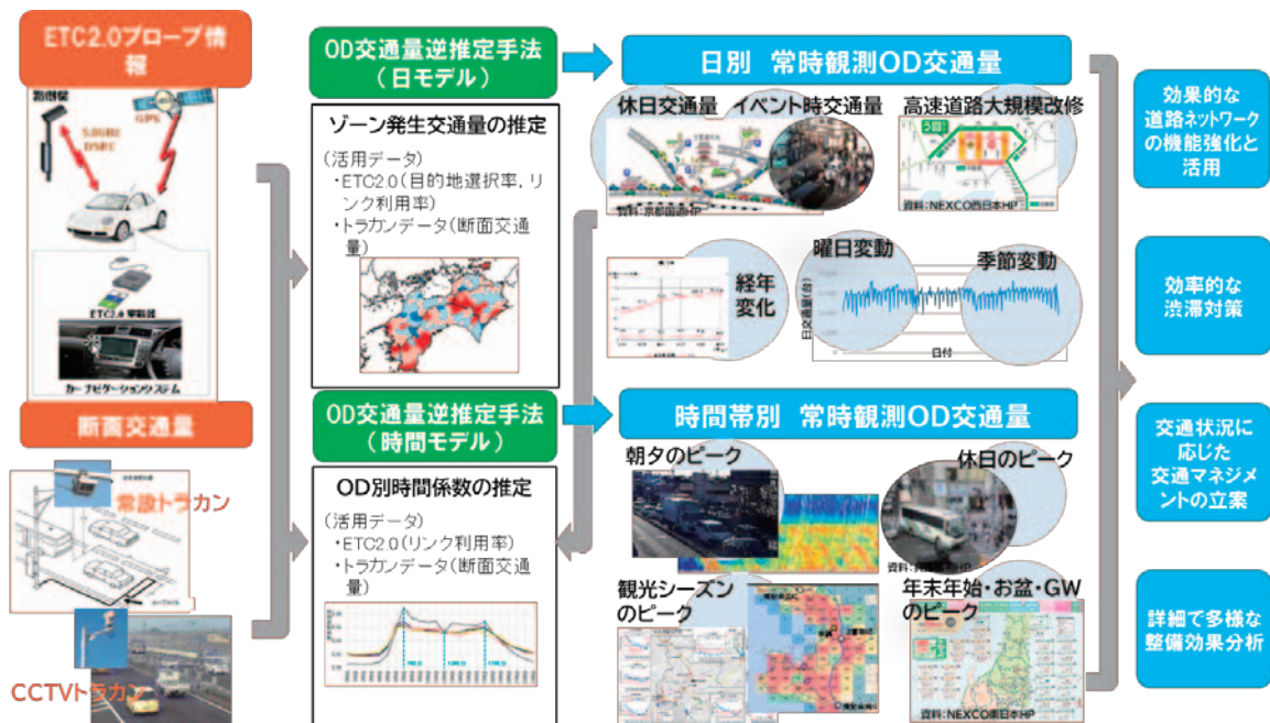
図 ETC2.0プローブ情報等を用いた常時観測OD交通量の推定 3)
