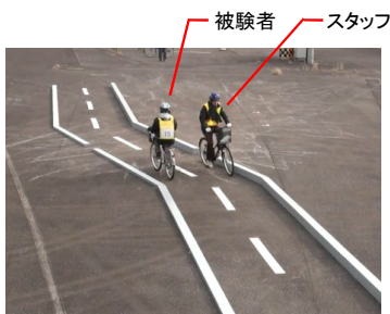
図-4 実験状況(幅員2.0m、シフト比1:4、 \Delta W=2.0m )
