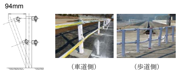
図 2 歩道側への最大変形量 写真 1 実験後の防護柵
