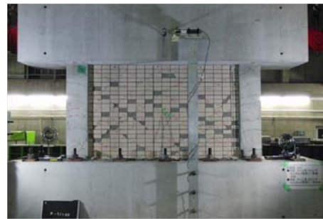
層間変形角 1/100 の下地モルタル 2 層塗りタイル 写真-1 柱梁付き壁試験体の静的加力試験
