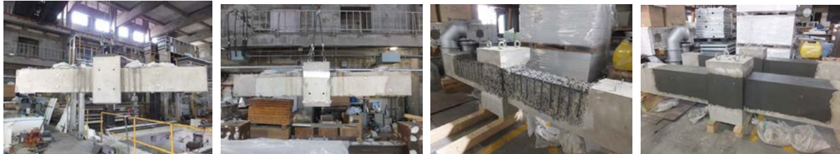
図 6 鉄筋コンクリート部材の損傷・修復過程の状況 (c), d)は梁下が上面
