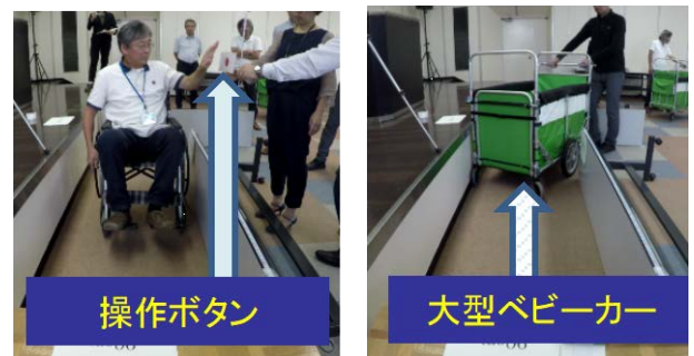
図3 介助対応型装置に具備すべき寸法などの要件の検証(左:操作ボタンの位置、右:廊下幅の確認)
