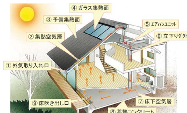
図-1 空気集熱式ソーラーシステムの概要 (冬期の日中)
