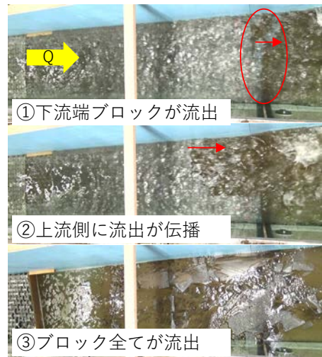
図-5 変状が連鎖的に進行するケース
