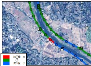
図-2 地震による堤防沈下状況表示例
