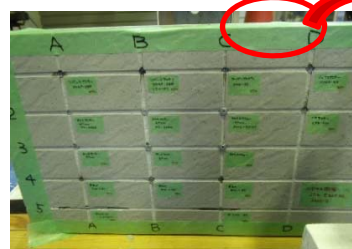
写真-2 アンカーピンの選定のための予備実験
