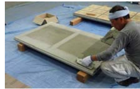
写真-1 模擬剥離を設けた ECP 試験体の作製
