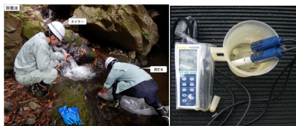
図-2 渓流水調査の様子（左：容器法による流量計測状況、右：ポータブル測定器による水質測定例）
