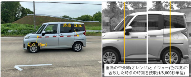
図-4 速度の真値の計測手法（試験走路） （左：試験車両、右：ハイスピードカメラの撮影イメージ）
