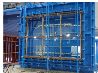
図-5 フロントサッシ接合部の要素試験での損傷例 図-6 フロントサッシのユニット試験体
