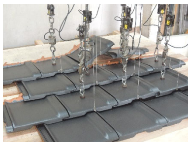
図-1 瓦屋根標準設計・施工ガイドライン 図-2 瓦屋根の载荷試験の実施例 (F形瓦の場合)
