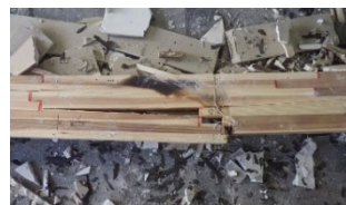
写真1 集成材の破壊部分(No.2)
