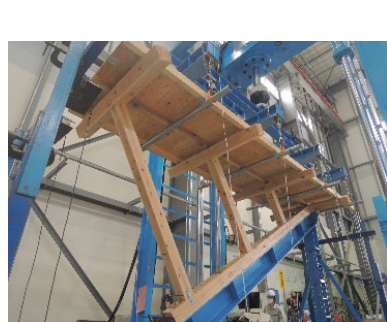
図-3 小屋組接合部の要素試験での損傷例 図-4 小屋組のユニット試験体
