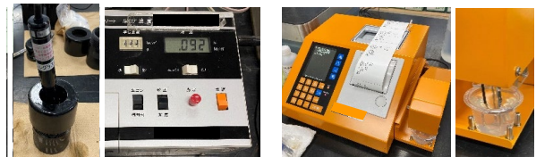
(d) 電極電流測定法 【ろ液抽出: 加圧ろ過】 (e) 電量滴定法 【ろ液抽出: 加圧ろ過】 写真-1 本実験で使用した塩化物量測定器
