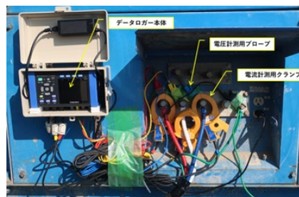
図-2 電力量計（クランプオンパワーロガー「HIOKI PW-3660」）
