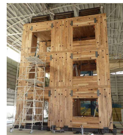
CLTパネル構造試験体
