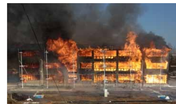
建物全体に火災が拡大した点火後34分時点の様子
