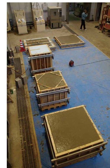
写真 1 作製中の実大試験体
