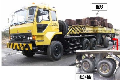
写真-4.2 荷重車の外観
