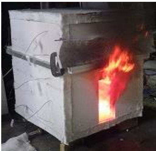
(a)けい酸カルシウム板 0.2TK 加熱中 (b)けい酸カルシウム板 0.2TK 実験後
