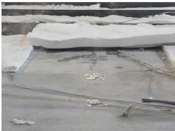
写真 2. 2. 6 コンクリートからの水分の漏出 （加熱開始後 22 分）
