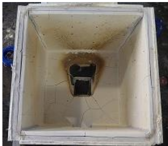
(a)けい酸カルシウム板 0.2TK 加熱中 (b)けい酸カルシウム板 0.2TK 実験後
