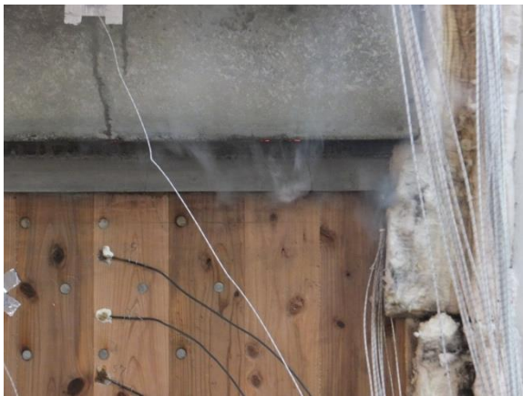
写真 2.2.9 無収縮モルタルから煙の漏出 （加熱開始後 120 分）
