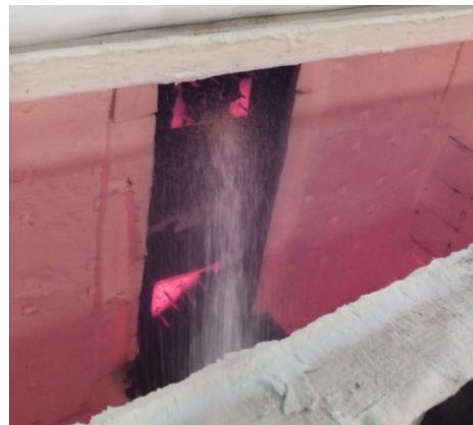
写真 2. 2. 22 消火時の燃焼状況
