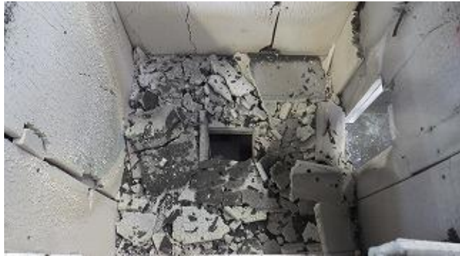
(d)強化せっこうボード (V) 実験後
