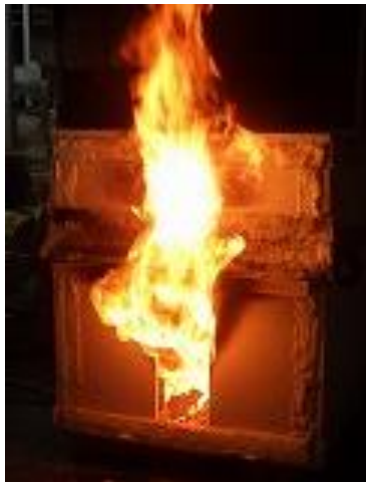
(e)構造用合板 (6面ビス留) 加熱中
