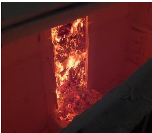
写真 2. 2. 21 加熱終了後の木材の燃焼状況
