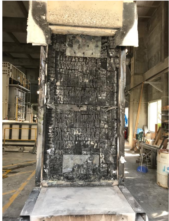
写真 2. 2. 15 加熱側全体状況 (上 : No. 1、下 : No. 2)
