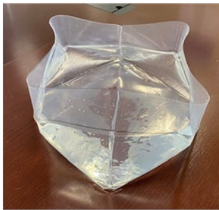
④ 型枠用遮水シートの水密性確認
