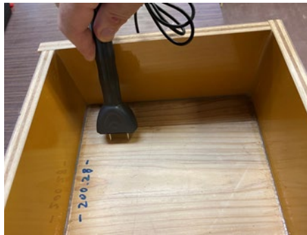
写真2.7.2 CLT試験体表面の電気抵抗式水分計による含水率の測定状況
