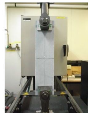
写真 2.6.4 せん断試験の状況
