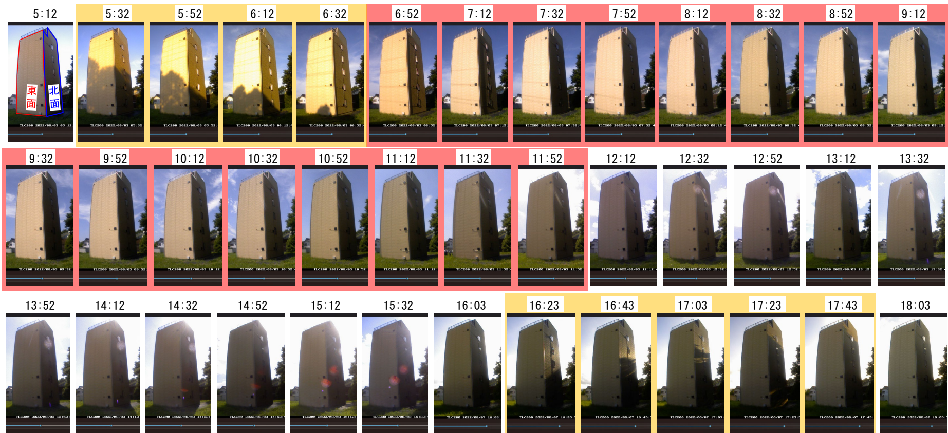
写真 2.5.6 対象建物に対する日射の当たり方の例 (2022/8、晴天時、東/北面)
