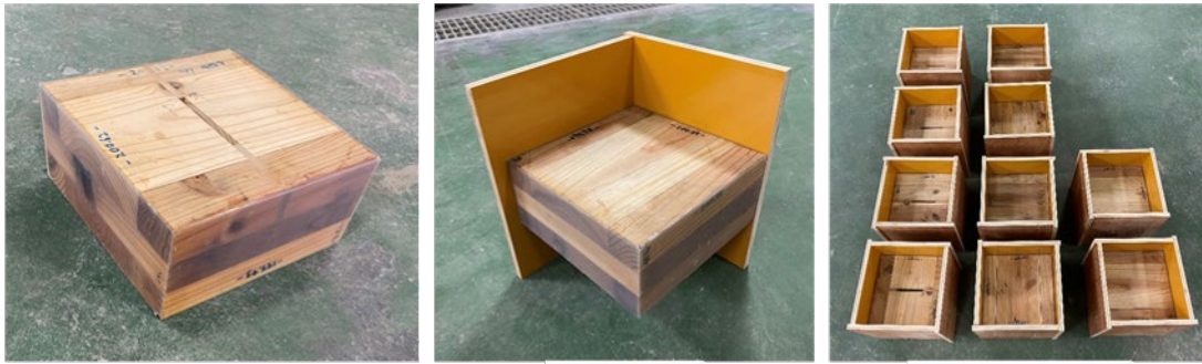
① CLT 側面の止水処理 (シリコン施工)
