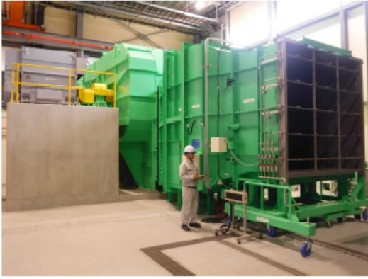
写真2.3.3 大型送風散水試験装置
