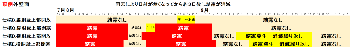
各種仕様による結露の状況
