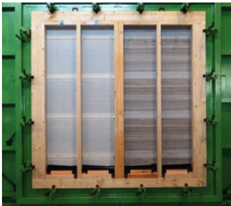
窯業系サイディング嵌合部の水密性試験
