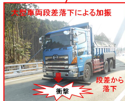
写真-4.6 固有振動数の確認試験状況
