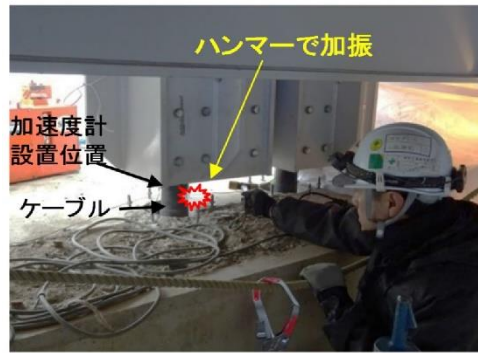
写真-4.5 浮上り防止対策ケーブルの加振状況
