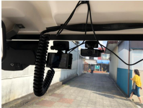
図 3.1.10 ドライブレコーダー設置状況
