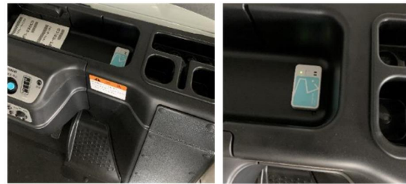
車両へのsoracom設置状況
