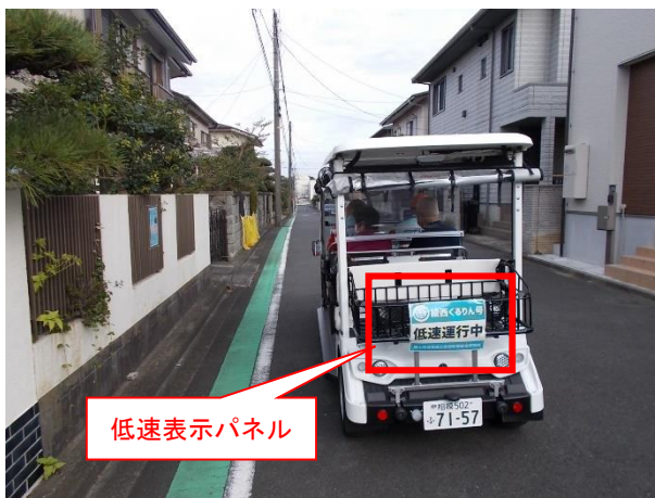
図 3.2.8 低速走行を示すパネルの設置
