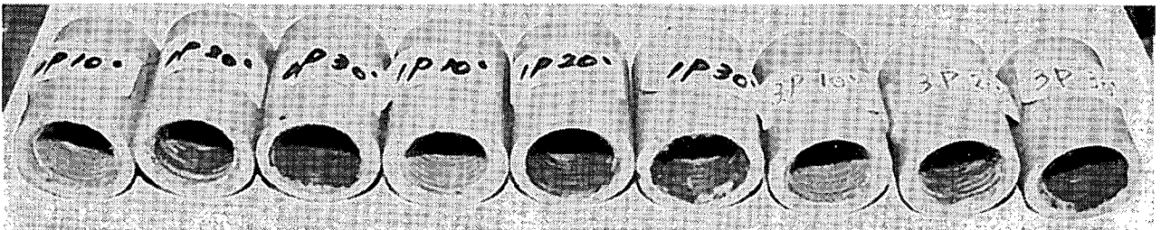
写真-1 浸漬実験後の鋳鉄ソケット（ラベル数値は塩素濃度と温度）
