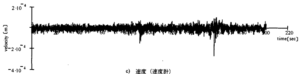
図-13(3) 船舶接岸時の栈橋挙動測定結果
