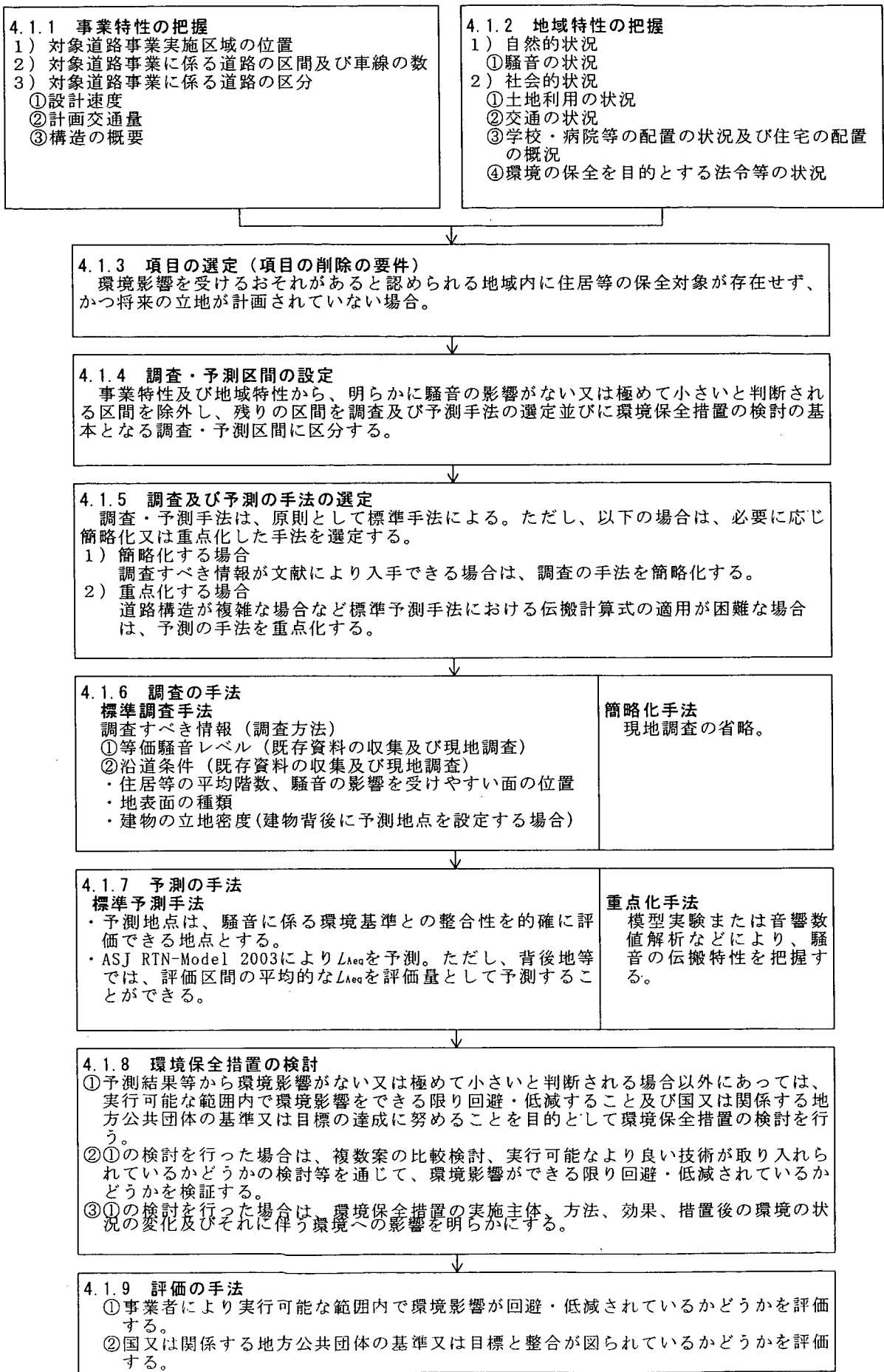
図-4.1 自動車の走行に係る騒音の環境影響評価における調査、予測及び評価の流れ
