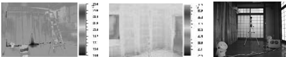
写真 1 1階南東隅角表面温度分布(改修前:室内 20.3^\circ\text{C} 、外気 7.8^\circ\text{C} 、改修後:室内 32.3^\circ\text{C} 、外気 9.3^\circ\text{C} )
