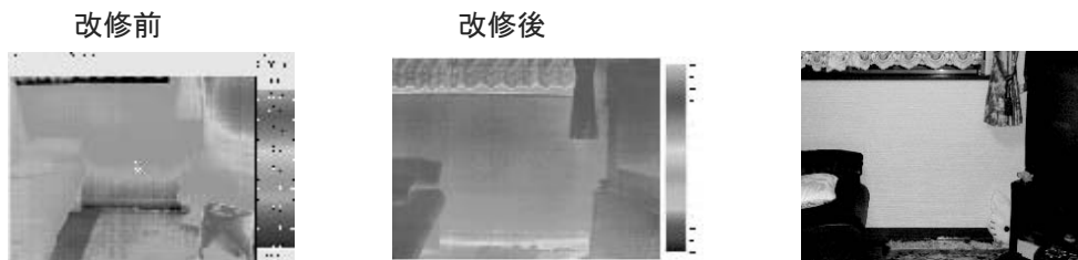
図4居間東側外壁表面温度分布(改修前:室内 18.8^{\circ}\text{C} 、外気 6.1^{\circ}\text{C} 、改修後:室内 19.4^{\circ}\text{C} 、外気 11.2^{\circ}\text{C} )
