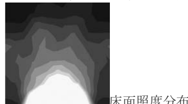
図 b 地面反射率が低く室内仕上げ面の反射率が高い場合(最も導光効果の高い場合)
