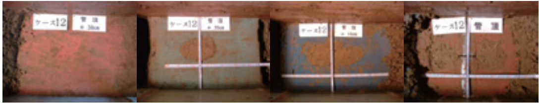
写真-4.11 case8 ゆるみ観測状況(管頂 30、20、10、0cm)
