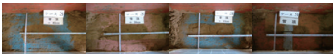
写真-4.6 case3 ゆるみ観測状況(管頂 40、30、10、0cm)
